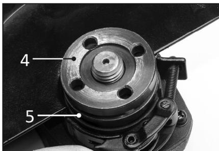
**Примечание:** при использовании проволочной щетки установка прижимной гайки не требуется. Перед началом использования устройства убедитесь, что щетка надежно закреплена.
